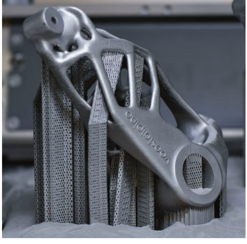
Beispiel für den 3D-Druck von Metallteilen
